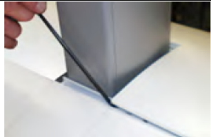
2) Hacer palanca para extraer las tapas superiores a ambos lados de la columna.
