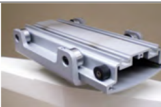
7) Deslizar el perfil a través del carro y volver a montar los topes.
