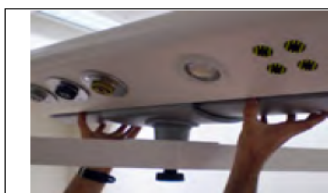
10) Alojar el perfil en el cabecero y girar los tornillos en T para retenerlo. Montar de nuevo todo lo anterior, siguiendo el proceso a la inversa desde el paso 5.
