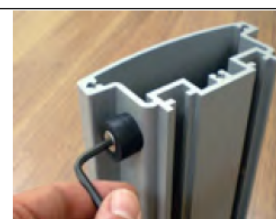
6) Una vez liberado, desmontar los topes de un extremo.
