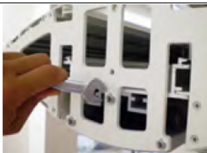
4) Extraer los tornillos que fijan por ambos extremos el perfil inferior a la brida.
