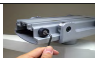
8) Si es necesario, para aligerar peso en el montaje del perfil, extraer tornillos que fijan las barras al yugo del carro. Volver a fijarlos una vez se termine el montaje.
