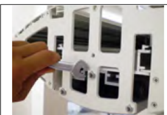
4) Extraer los tornillos que fijan por ambos extremos el perfil inferior a la brida.
