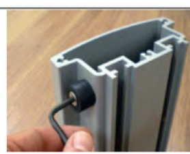
6) Una vez liberado, desmontar los topes de un extremo.
