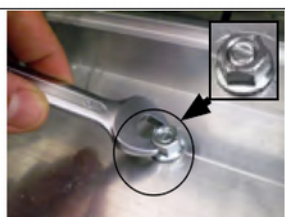
5) A flojar las tuercas de la cara interior y dejar las cabezas del esparrago alineadas para liberar el perfil.
