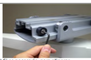
8) Si es necesario, para aligerar peso en el montaje del perfil, extraer tornillos que fijan las barras al yugo del carro. Volver a fijarlos una vez se termine el montaje.
