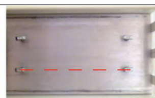
9) En la cara donde ira apoyado el perfil, comprobar que los tornillos en T, estan perfectamente alineados.
